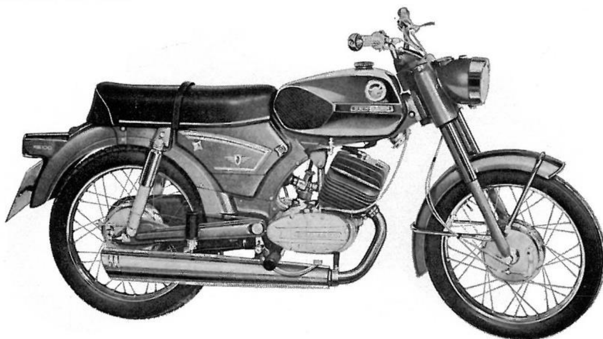
Photo 3 KS 125 avec moteur refroidi par l'air de circulation et cylindre à culasse en éventail, 5 vitesses, sélecteur au pied
